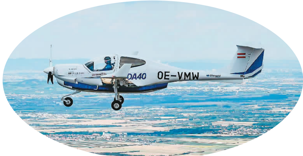
万丰钻石电动飞机eDA40充电20分钟可以续航90分钟，与传统活塞式飞机相比，运营成本可降低40%以上。图为eDA40成功试飞。 万丰集团供图
