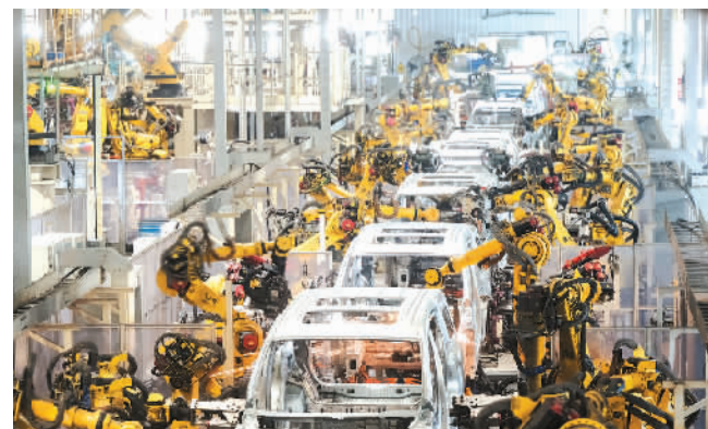
在位于湖北武汉市经开区的岚图汽车电动化焊装车间，机器人在作业。 新华社记者 肖艺九摄
