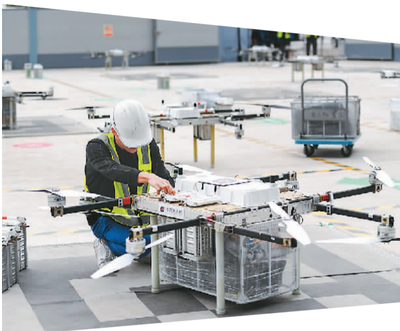
▲ 在深圳宝安区丰翼无人机运营中心，地勤人员取出无人机载货箱并更换电池。 新华社记者 毛思倩摄
