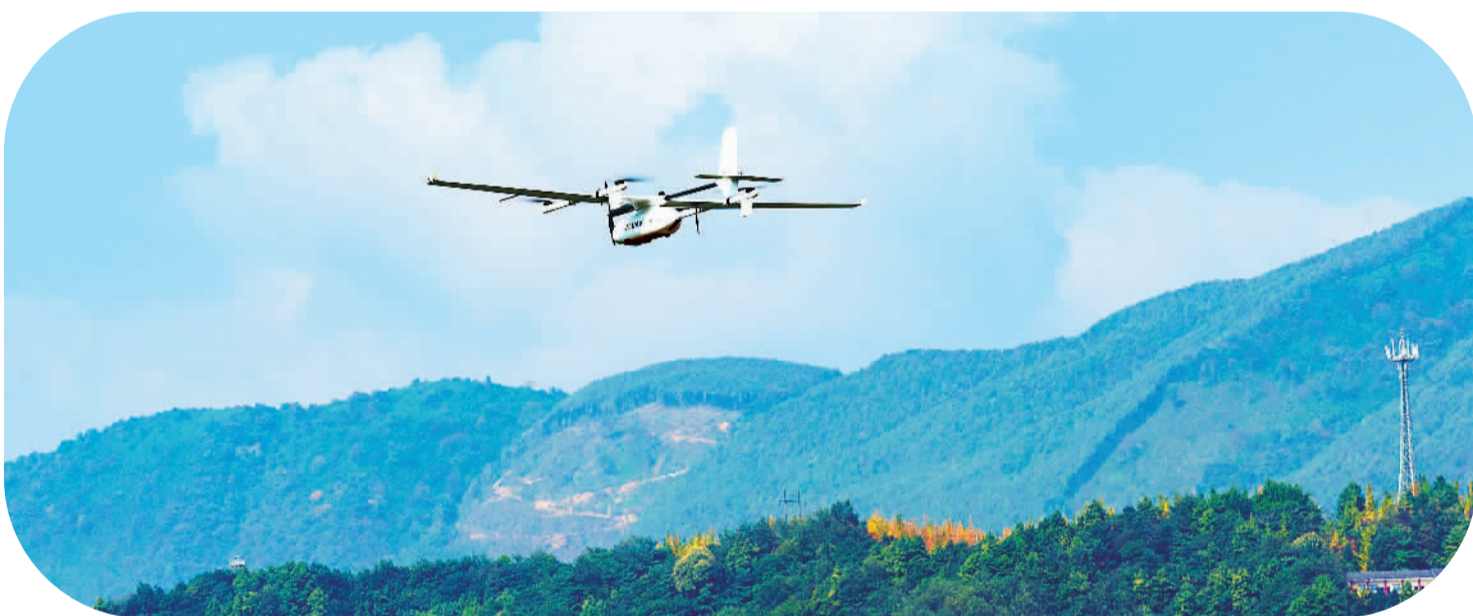
▲ 江西省宜春市奉新县，成都纵横大鹏无人机科技有限公司生产的无人机搭载激光雷达，采集位于奉新县风场选址的1:2000点云成果。 杨江春摄
