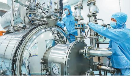
固本生物科技有 限公司工人们紧 张忙碌地进行百 合甘草饮、黑蒜生 姜黄精饮、胡萝卜 泥等产品的生产。 图为该公司超临 界流体萃取低温 真空浓缩自动化 生产线上,工作人 员正在查看设备 运行情况。
