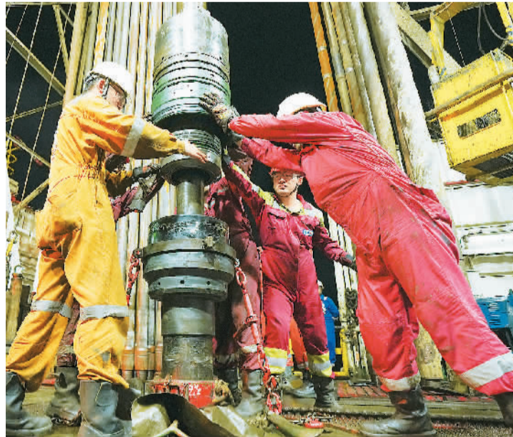
一体式水下井口关键部件组装场景。
