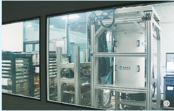
图③：图为中国第三代自主超导量子计算机“本源悟空”。
