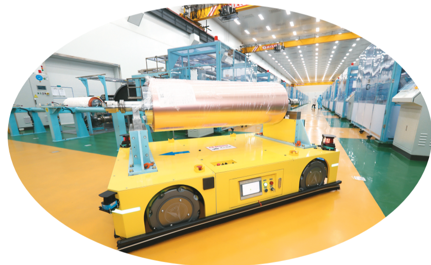
图为在浙江花园新能源股份有限公司铜箔生箔车间内，自动导引车(AGV)正在协助生产车间完成自动取放卷及跨车间转运成品等。 包康轩摄（人民视觉）
