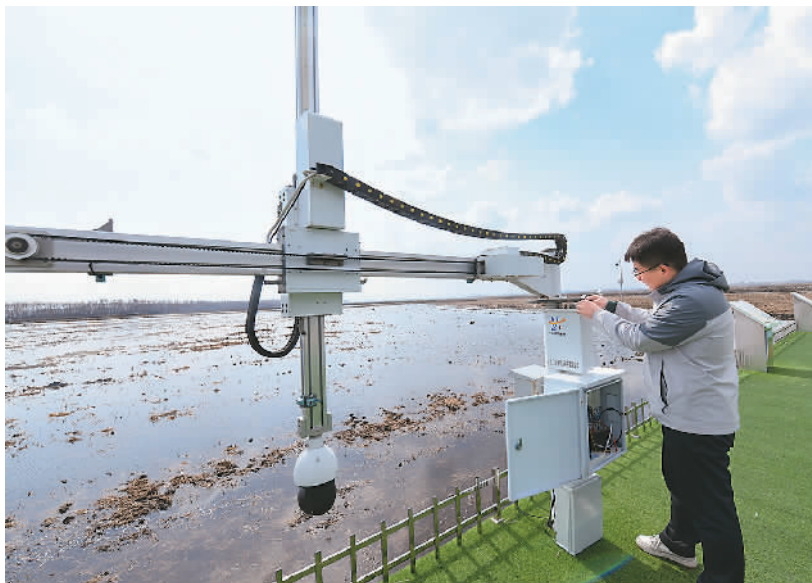
4月3日，在黑龙江北大荒农业股份有限公司友谊分公司一地块，农技人员在检测大数据和物联网技术终端。该终端通过50余个点位500余套设备进行数据采集、整合及分析，最终形成数据模块，助力春耕生产作业。 新华社记者 王松摄
