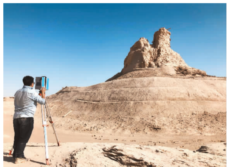
▲技术人员用三维激光扫描技术为楼兰古城佛塔遗址建立数字化档案。 中铁西北科学研究院有限公司供图
