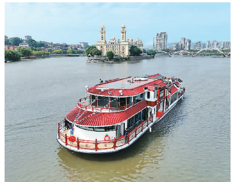
近日，福建首艘自主设计建造的纯电动大型高端客船“闽江会客厅”在闽江首航。全船全长38.48米，型宽10.1米，能够载客212人，满载时最大航速达20公里每小时，在观光航速航行下续航10小时。图为“闽江会客厅”纯电动客船在闽江首航。 新华社记者 林善传摄
