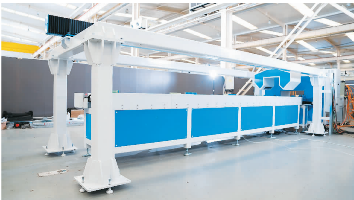
袁鹄团队设计生产的型钢在线视觉检测系统。受访者供图
