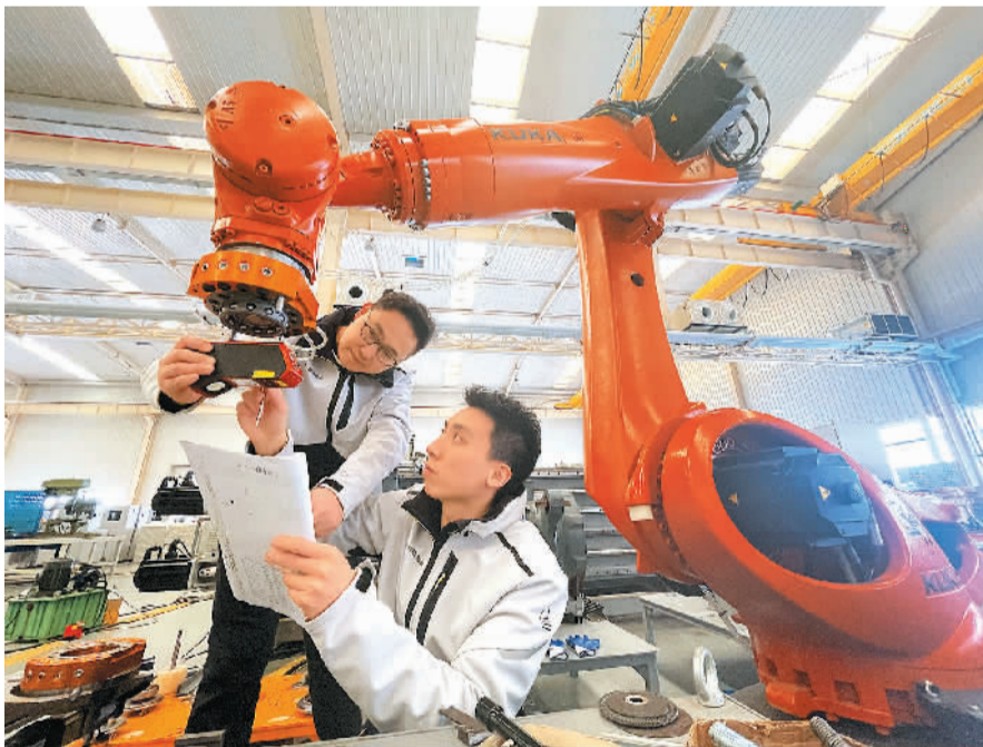
袁鹄(右)与技术人员研究为工业机器人适配3D视觉系统。受访者供图
