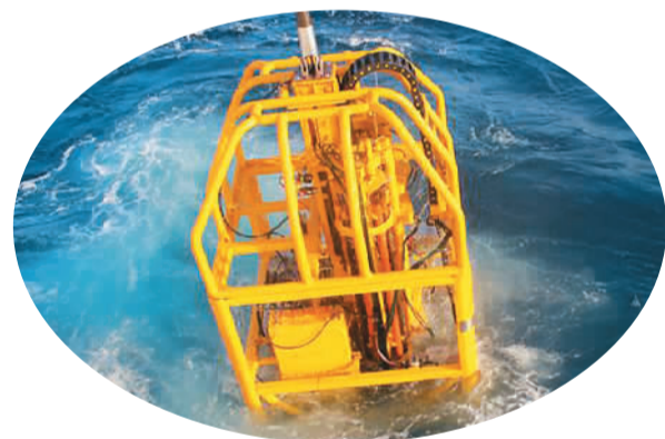
“海牛II号”入水，开始下潜进行钻探作业。 新华社发
