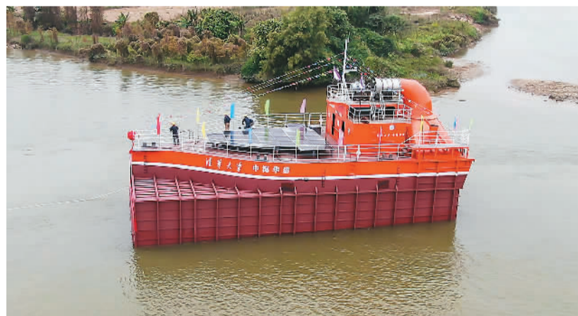
1月26日，中国首台超100千瓦的气动式海浪能发电装置“华清号”在广东省江门市新会区古井镇下水，该设备能适应台风海况。姜晓丹、林嘉辉摄影报道
