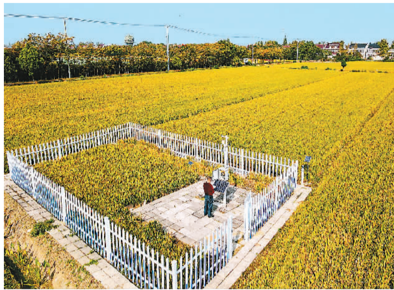
▲在江苏省如皋市磨头镇天阳社区农田示范区投入使用的智能化田间气象站，可随时获得风速、日照、温度等16项数据，并对信息进行上传、存储、分析，助力农业生产和特色产业发展。图为如皋市水务局农田水利试验站工作人员正在查看当日的气象数据。吴树建摄（人民图片）
