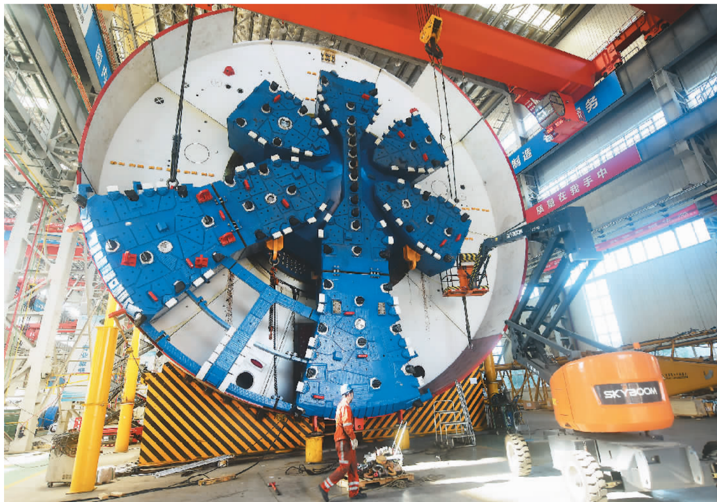
中铁“1398号”超大直径盾构机由浙江中铁装备研发制造，是目前华东地区生产的最大直径泥水平衡盾构机，刀盘直径为15.4米，总重约4000吨，建成后用于上海崇太（崇明岛—太仓）过江隧道工程项目。图为近日，在位于浙江杭州的中铁装备盾构机生产基地，工人正在生产组装中铁“1398号”超大直径盾构机。
