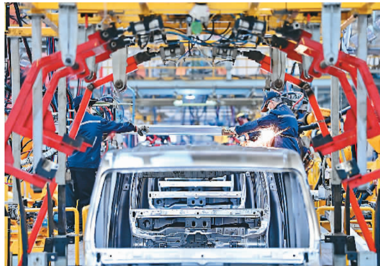
江西省赣州市经济技术开发区一家新能源汽车制造公司车间内，员工在焊接组装出口南美国家的新能源电动汽车。朱海鹏摄（人民视觉）
