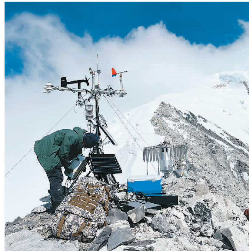
▲建立卓奥友峰极海拔气象观测体系，有助于揭示青藏高原冰冻圈变化过程和机理。图为卓奥友峰科考队队员在架设自动气象站。卓奥友峰科考队提供（新华社发）
