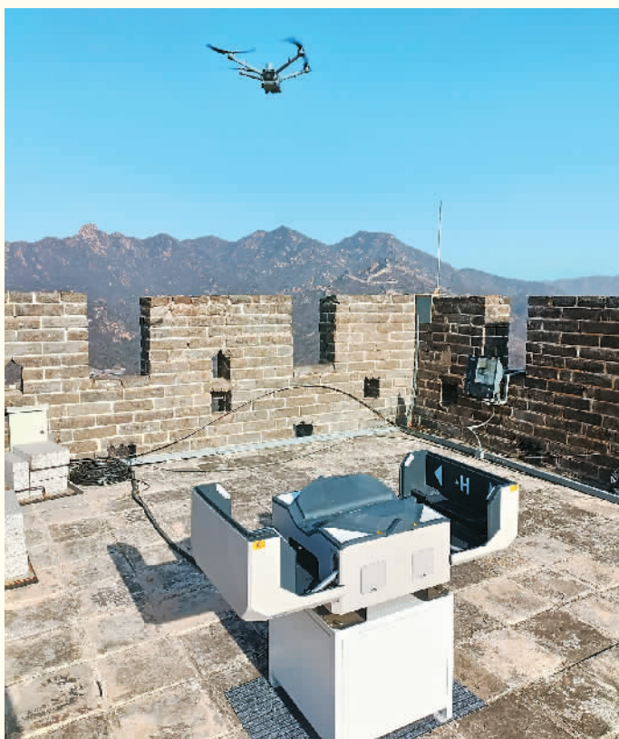
▲ 绿航院自主研发的油电混合动力复合翼无人机。
