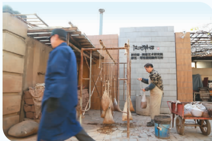
◀ 工作人员对澄滤后的黄河泥进行脱水。
