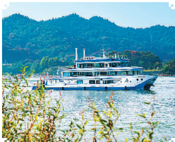
10月11日，中国首艘氢燃料电池动力示范船“三峡氢舟1”号在湖北宜昌首航。该船预计每年可替代燃油103.16吨，减少二氧化碳排放343.67吨。图为“三峡氢舟1”号。新华社记者肖艺九摄
