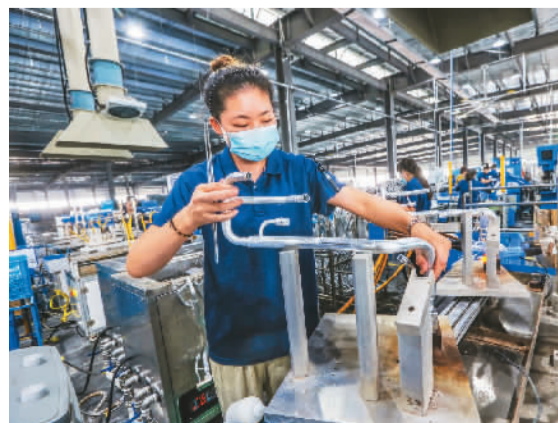
安徽省马鞍山市当涂县经开区抢抓长三角一体化发展重大机遇,加快发展新能源及高端装备制造业,全面推进产业升级。图为经开区腾龙汽车零部件制造有限公司某项目自动化生产线上,工人赶制汽车空调弯管。 王文生摄(人民视觉)
