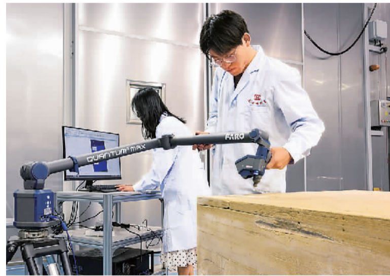
在甘肃敦煌研究院多场耦合实验室中，工作人员对庆阳北石窟寺砂岩样品进行三维扫描。 新华社记者 李贺摄
