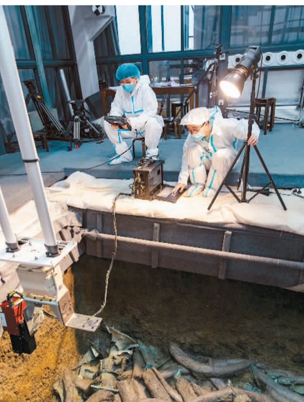
在三星堆遗址考古发掘现场，考古人员用高光谱成像扫描仪对文物进行光谱拍摄，以识别文物的材料和属性。
