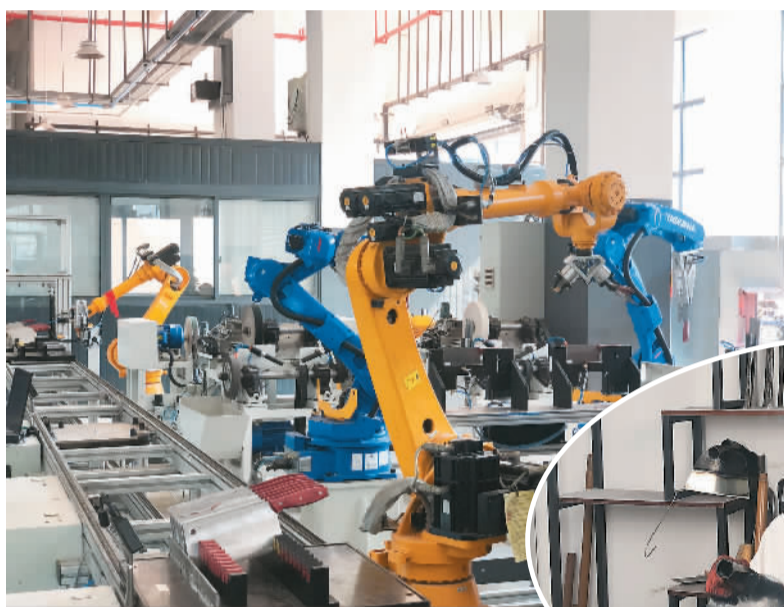
合心集团车间的磨削自动化生产线正在作业。
