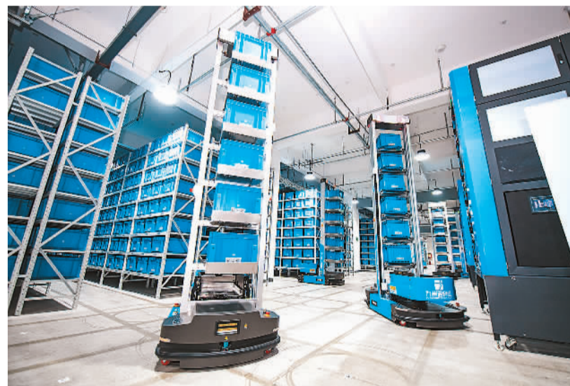
新疆维吾尔自治区昌吉回族自治州现代医疗物流仓储基地今年4月正式投入运营，具备批发配送和应急储备功能。图为7月3日，该基地药品库，智能拣选机器人在进行药品调运。 何龙摄（人民视觉）
