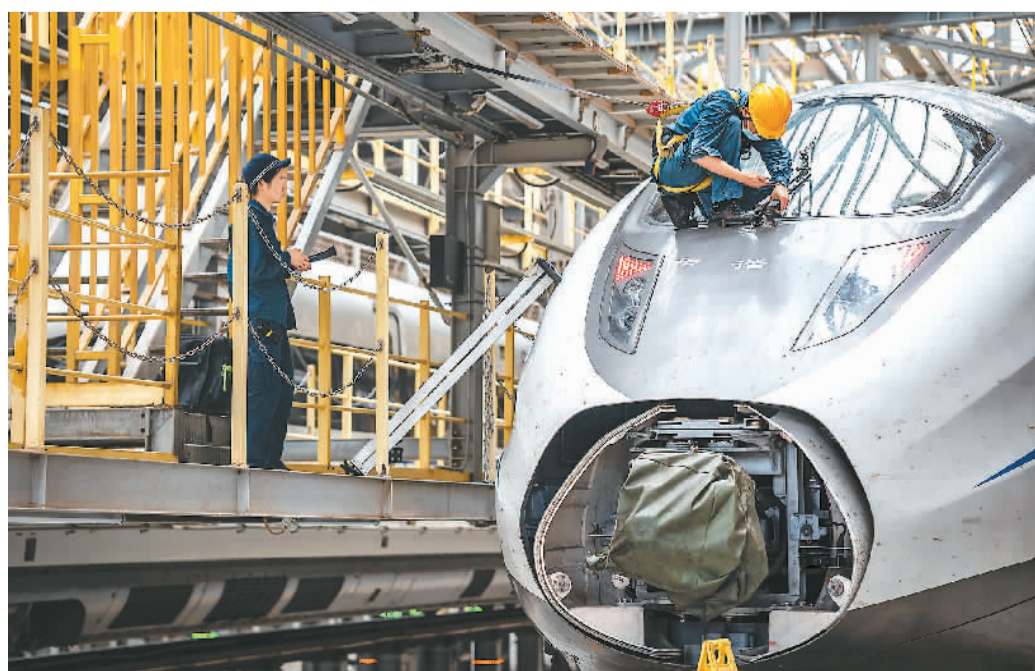
近日，中国铁路昆明局集团有限公司昆明车辆段的工作人员加大对动车组的检修保养力度，确保每一组动车组“健康”上线，守护旅客暑期平安出行。图为动车组地勤机械师(右)在更换动车组雨刮器。新华社记者 胡超摄
