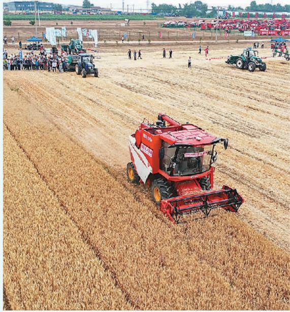
近日,由农业农村部农业机械化总站、山东省农业农村厅等主办的中国农机推广田间日活动在山东潍坊举行。活动现场的数台智能农机在无人驾驶的情况下,顺利完成了收获、打捆、耕整、播种等农事生产。据悉,这些农机配置无人驾驶系统后,不仅实现了自动出入库、智能规划路径、双机协同、机具自动控制等功能,还通过智能传感、远程通信等技术应用,实现了田间障碍物的自动识别、自动避障。图为在潍坊坊子区潍柴雷沃智慧农业示范基地,一台无人驾驶联合收割机在田间进行麦收作业。
