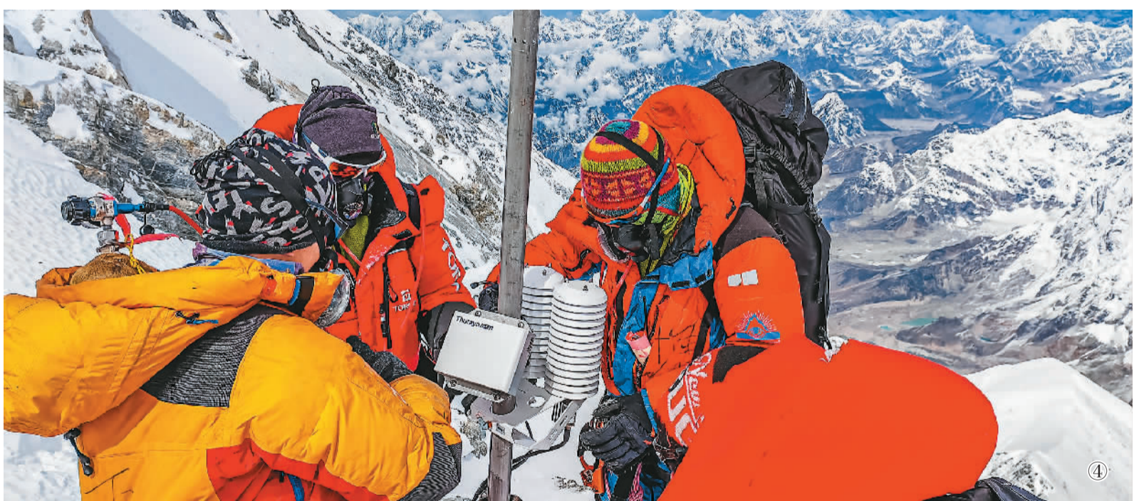
图④：科考登顶队员在珠峰海拔约8830米处维护升级自动气象站。
