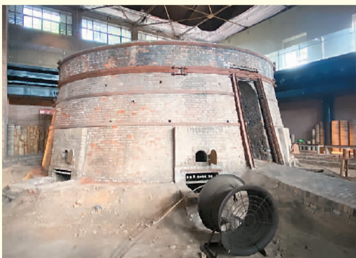
江西景德镇陶瓷工业遗产博物馆展出的镇馆之宝之一，即间歇式煤烧倒焰窑，俗称“包子窑”。
