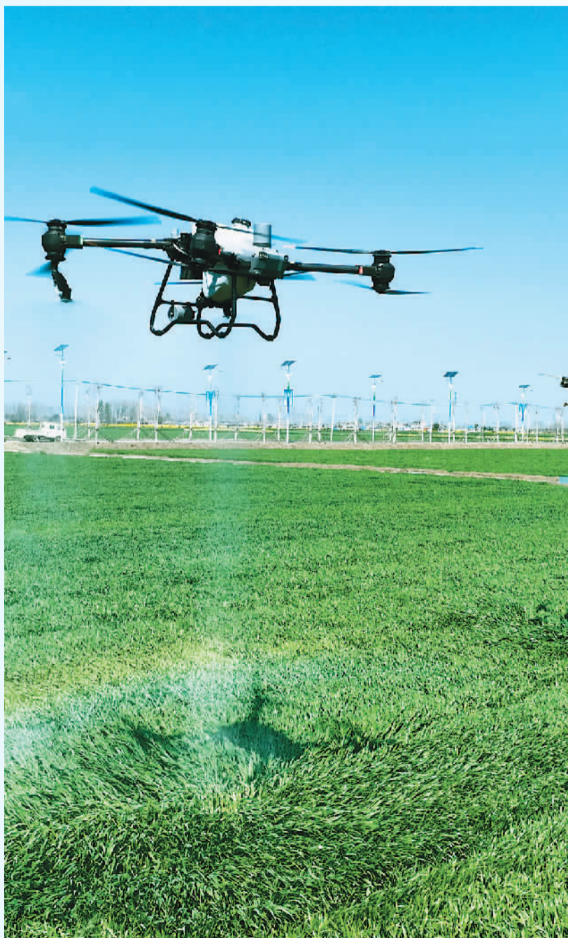
▲在江苏省淮安市洪泽区岔河镇南街村高标准农田里，植保无人机在进行防虫害喷洒作业。 殷潮摄（人民视觉）
