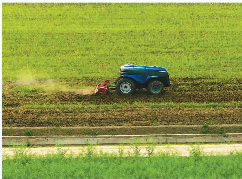
▲安徽省芜湖市繁昌区新港镇新东村高标准农田里，新能源无人驾驶农机正在旋耕作业。 肖本祥摄（人民视觉）
