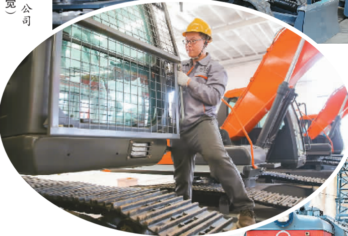
江苏省连云港市路友重工有限公司生产车间内，工人正在装配挖掘机。 王健民摄（人民视觉）
