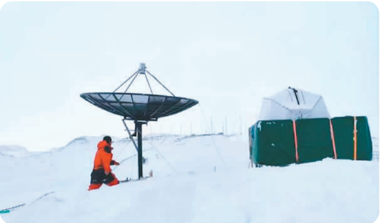
▲中国第39次南极科考队在中山站附近的仙女峰完成了3米口径低频射电望远镜的安装和调试。第39次南极科考队供图
