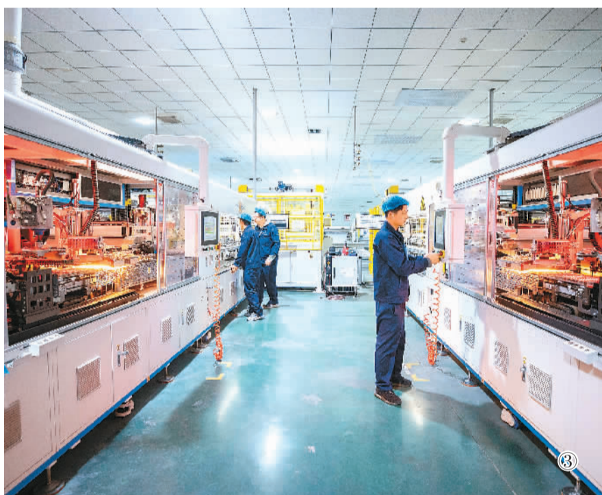
图①：山东省东营经济技术开发区山东国瓷功能材料股份有限公司，AI工业视觉识别品质检测系统正在对生产出的汽车用蜂窝陶瓷颗粒捕捉器产品进行质量检测。 周广学摄(人民视觉)
