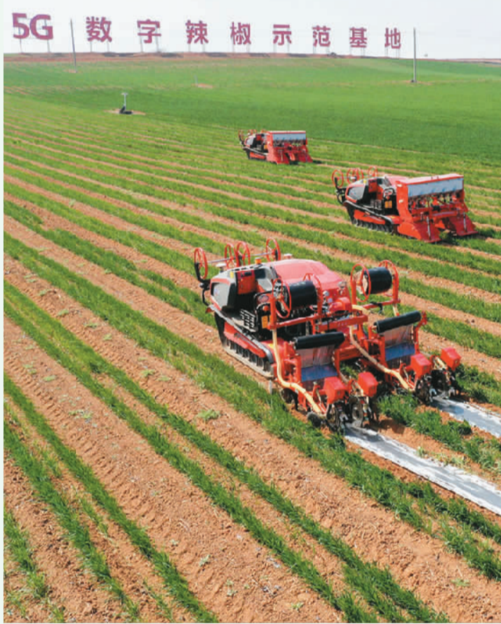
河南省洛阳市新安县铁门镇依托辣椒种植的地理优势,以千唐红农文旅融合示范带为统领,规划辣椒种植基地,并运用5G、物联网、大数据等现代信息技术,创建5G数字辣椒示范基地,利用5G无人驾驶辣椒直播机,实现施肥、旋耕、铺管、覆膜、播种一次性作业。图为3月14日,新安县铁门镇千唐红5G数字辣椒种植基地,5辆无人驾驶辣椒直播机正在田中作业。张怡照摄(人民日报)
