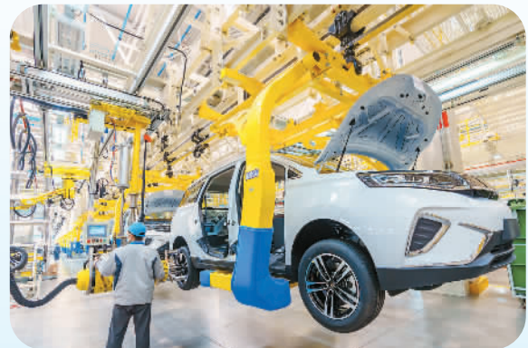
近日,在山西省运城市大运新能源汽车冲焊车间智能化生产流水线,智能焊接机械臂进行新能源汽车车架焊接作业。闫鑫摄(人民视觉)
