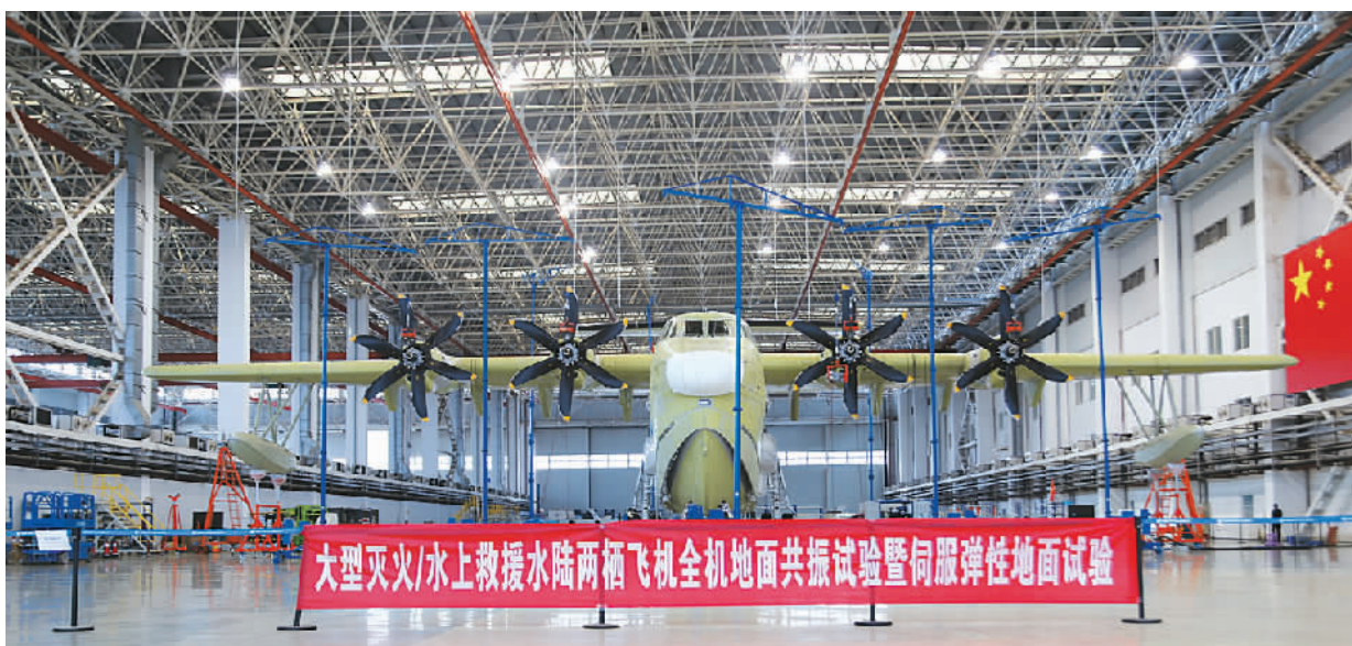
AG600M进行全机地面共振试验暨伺服弹性地面试验。
