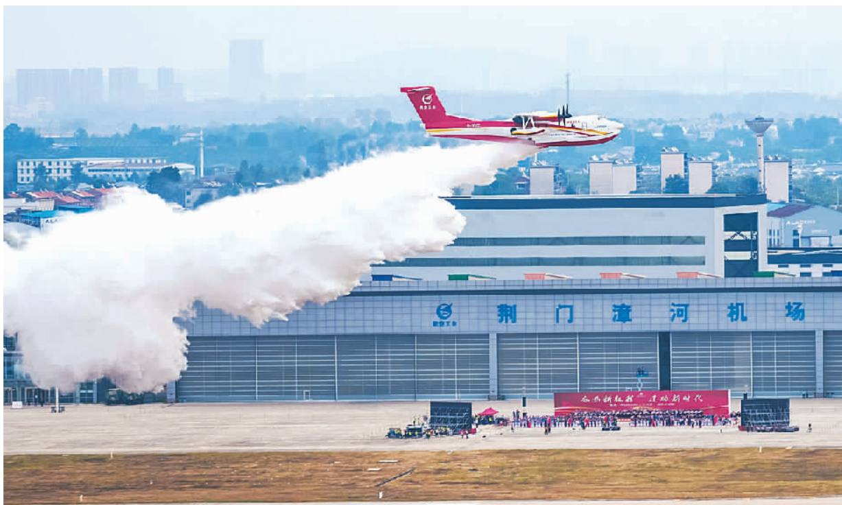
2022年9月27日，AG600M灭火机在湖北荆门漳河机场成功完成12吨投水试验。
