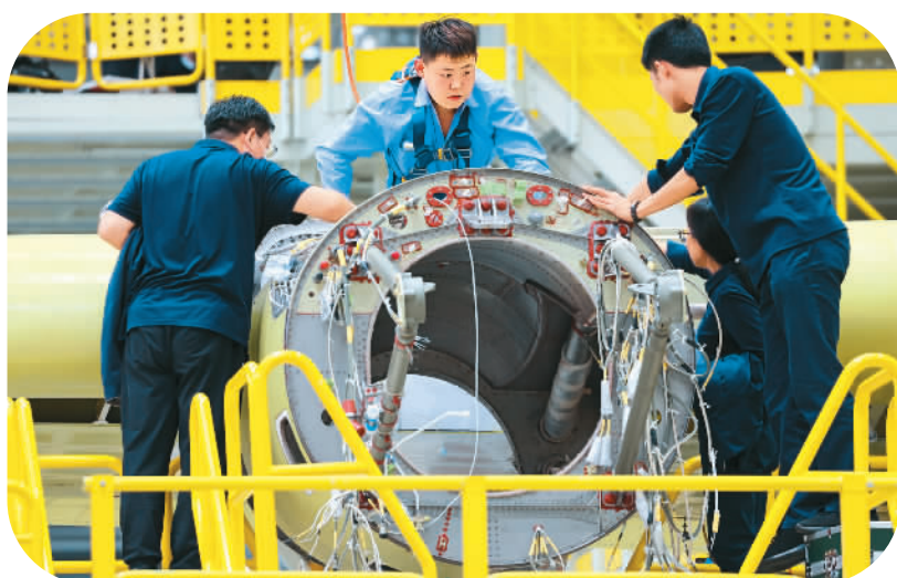
2022年11月7日，工程师在珠海中航通飞华南飞机工业有限公司AG600M总装线上进行发动机总装作业。
