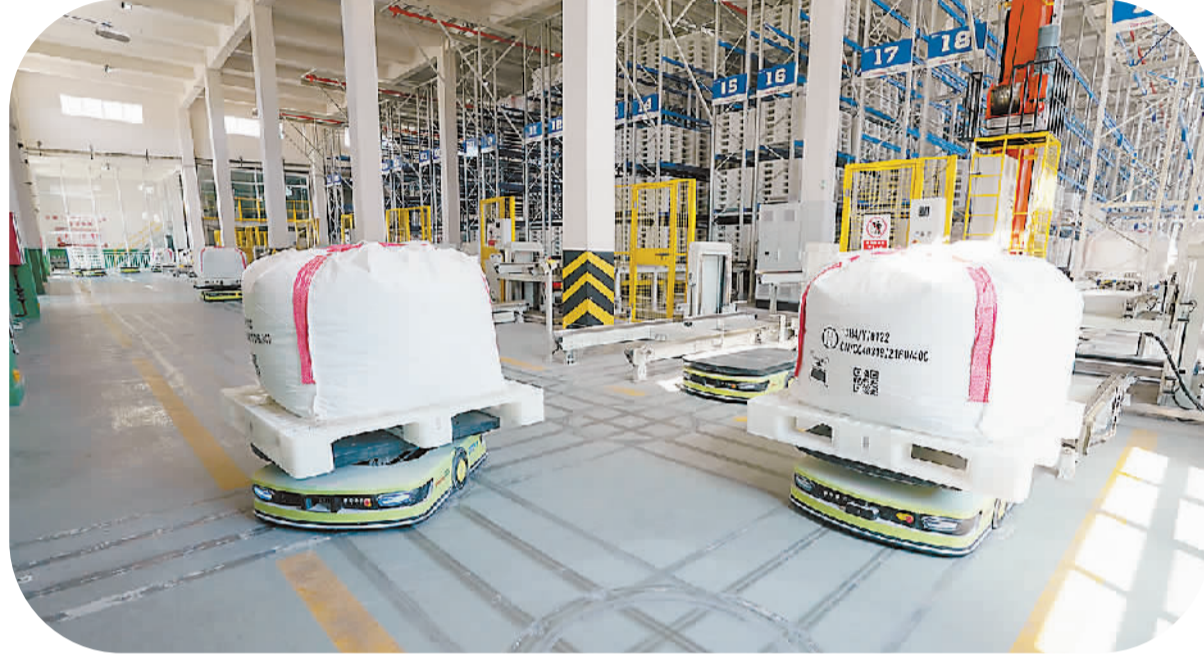
▲江西赣锋锂业股份有限公司依托云计算、AGV、大数据等先进制造技术，建设智能化仓储系统。图为不久前，万吨锂电工厂智能立体仓库中，工业搬运机器人自动搬运物料。
