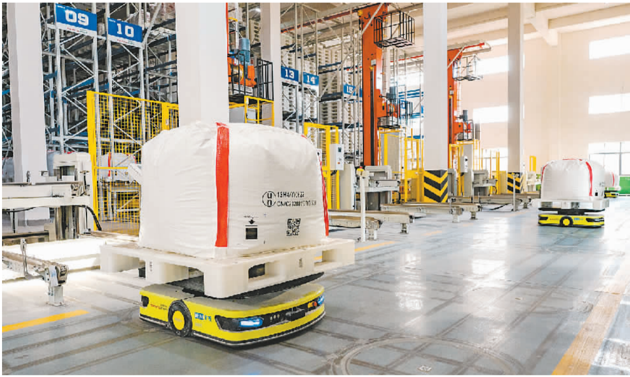
江西省新余市高新区通过支持企业利用现代数字信息技术、人工智能技术等对产业进行全方位、全链条改造，促进锂电、光伏、智能制造等重点行业数字化转型。图为在高新区锂电新能源产业园赣锋锂业的车间内，AGV转运机器人在智能程序下执行打托备货工序。赵春亮摄（人民图片）
