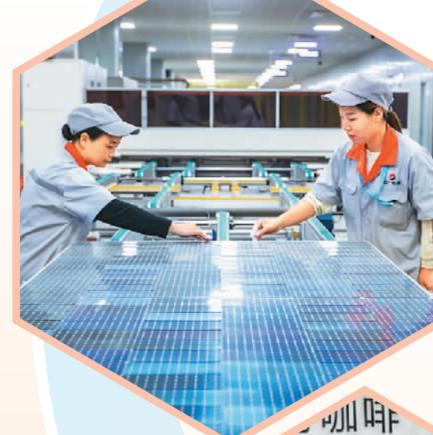
浙江省金华市金东区工业园区,一家自动化生产光伏太阳能组件公司技术工人正在对外订单产品进行单片质量检测校验。杨梅清摄(人民视觉)
