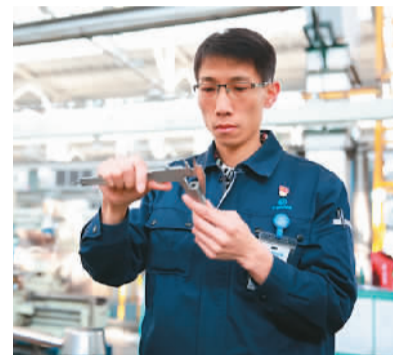
洪家光在车间用卡尺测量加工的工具零件。新华社发
