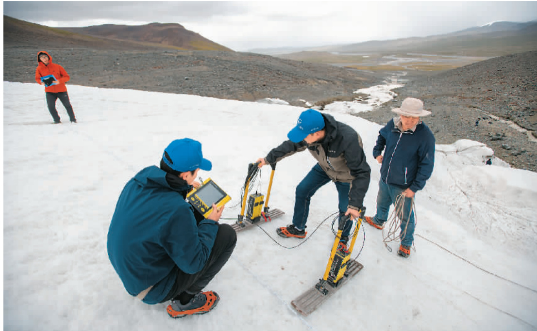
▲ 冰川观测是2022年江源综合科学考察的重要内容之一。来自长江科学院的科考队员们首次使用地质雷达,结合遥感等技术,探测江源冰川厚度,匡算冰储量。图为科考队员在格拉丹东雪山使用地质雷达探测冰川。 ◀ 科考队员在长江源区进行科考工作。
