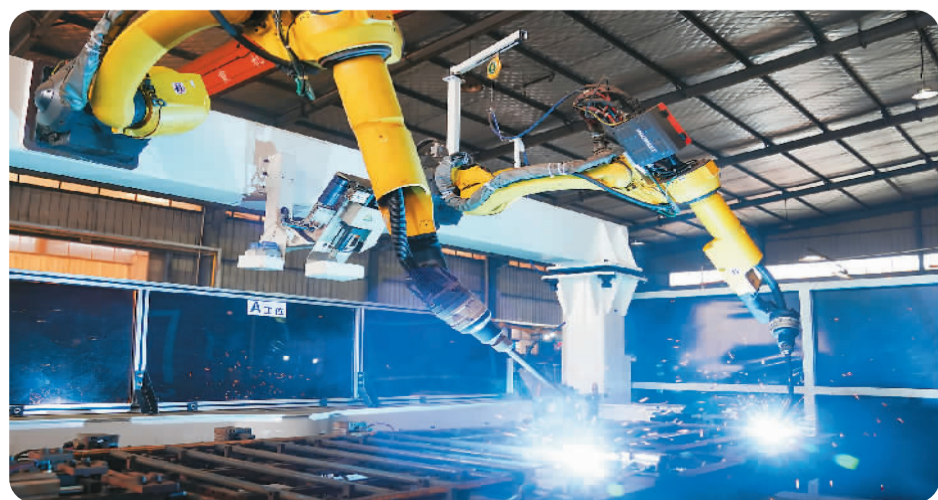
▲近年来，江西省新余市围绕5G应用、工业互联网等新兴领域，布局数字产业和数字经济，建设一批“智能工厂”“数字化车间”，推动产业转型升级。图为新余一家企业的焊装生产车间，自动机械臂在进行自动焊接作业。（人民图片）
