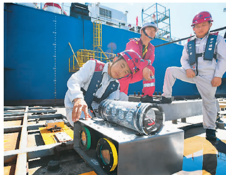
由中交一航局施工的深中通道E19沉管近日在珠江口伶仃洋海底成功实现毫米级对接。在此次沉管隧道安装中，项目测绘团队进行了一项水下精准定位技术创新试验，为沉管在海底安装对接提供更加可靠、更高精度的定位数据。深中通道海底隧道全长6845米，其中沉管段长5035米，由32节沉管和1个最终接头组成。
