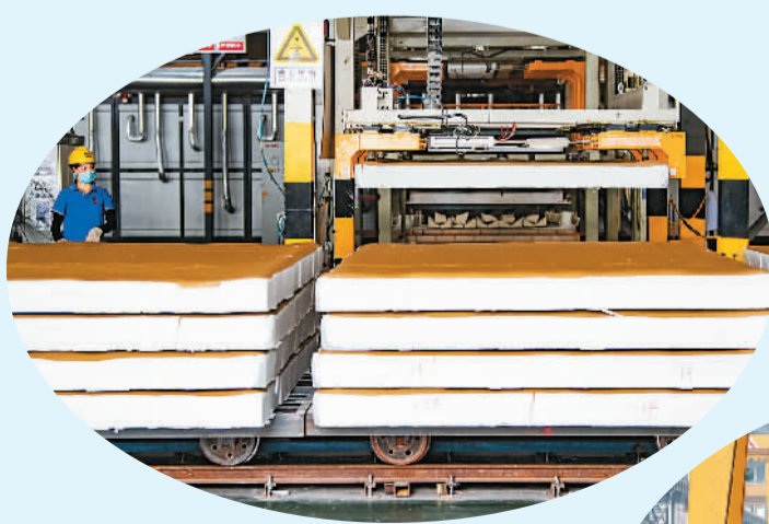
▲6月22日，江西省新余市江西中材新材料公司发泡陶瓷墙体材料生产线上，工人忙碌于生产新型绿色环保建筑材料。 赵春亮摄（人民视觉）
