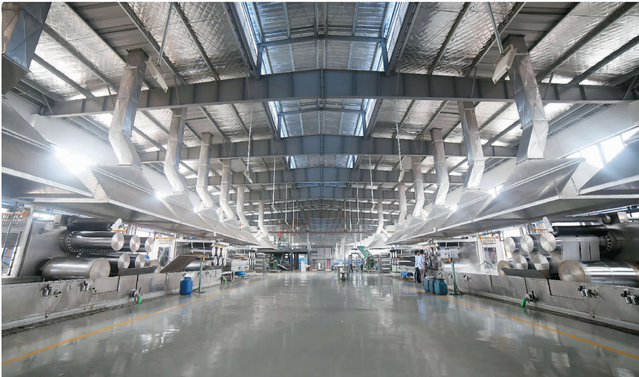
图为浙江省宁波大发化纤有限公司用来制作再生涤纶短纤维的牵伸工艺生产车间。
