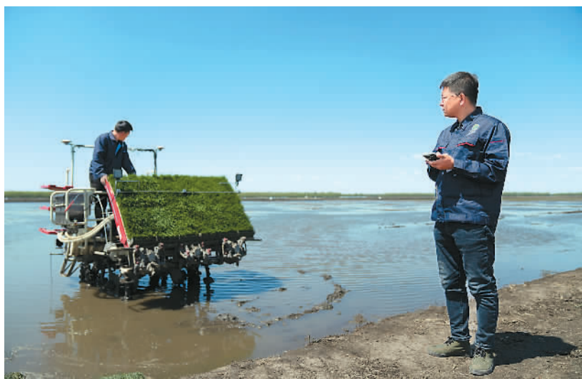
2022年5月31日，在黑龙江省北大荒，农民用手机操控带有北斗导航系统的插秧机工作。新华社记者 王建威摄
