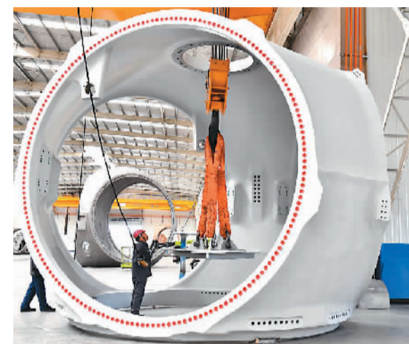
山东省惠民县近年来以新能源产业为抓手助推县域经济高质量发展，依托原有风电产业基础，引入国内风电行业龙头企业，着力打造大功率风电装备制造产业基地。图为在风电装备制造产业基地涂装车间，工作人员在吊运风电轮毂。
