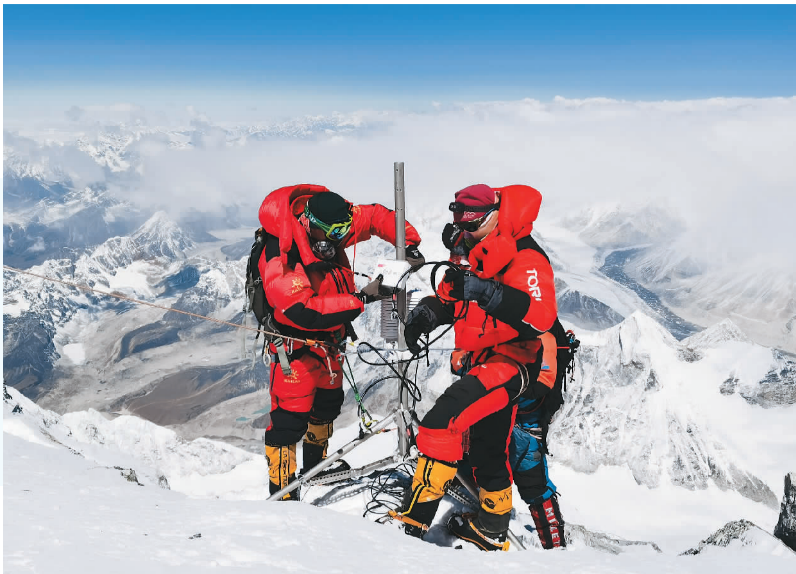
▲科考队员在珠峰海拔8830米处架设世界海拔最高自动气象站。
