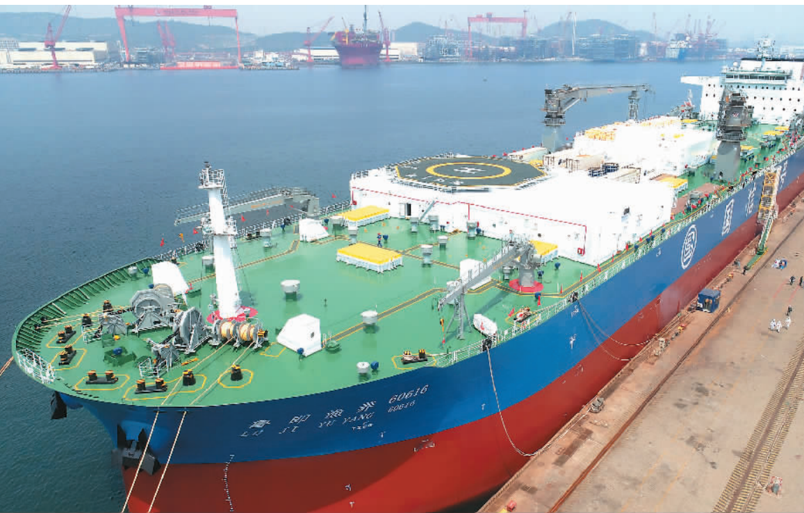
5月20日，全球首艘10万吨级智慧渔业大型养殖工船“国信1号”在中国船舶集团青岛北海造船有限公司交付运营。该船投资约4.5亿元，船长249.9米，排水量13万吨，载重量10万吨，设15个养殖舱，养殖水体近9万立方米，以“船载舱养”模式开展大黄鱼、石斑鱼、大西洋鲑等名贵鱼种养殖，设计年产高品质鱼类3700吨。本次交船运营后，预计第一批高品质工船大黄鱼将于今年秋季起捕上市。 张进刚摄 (人民视觉)
