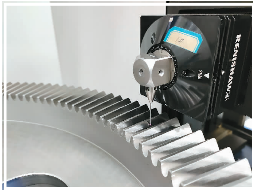
周元生团队在本次比赛中展示的“面齿轮高效精密智能制造”中的在机测量关键技术。
